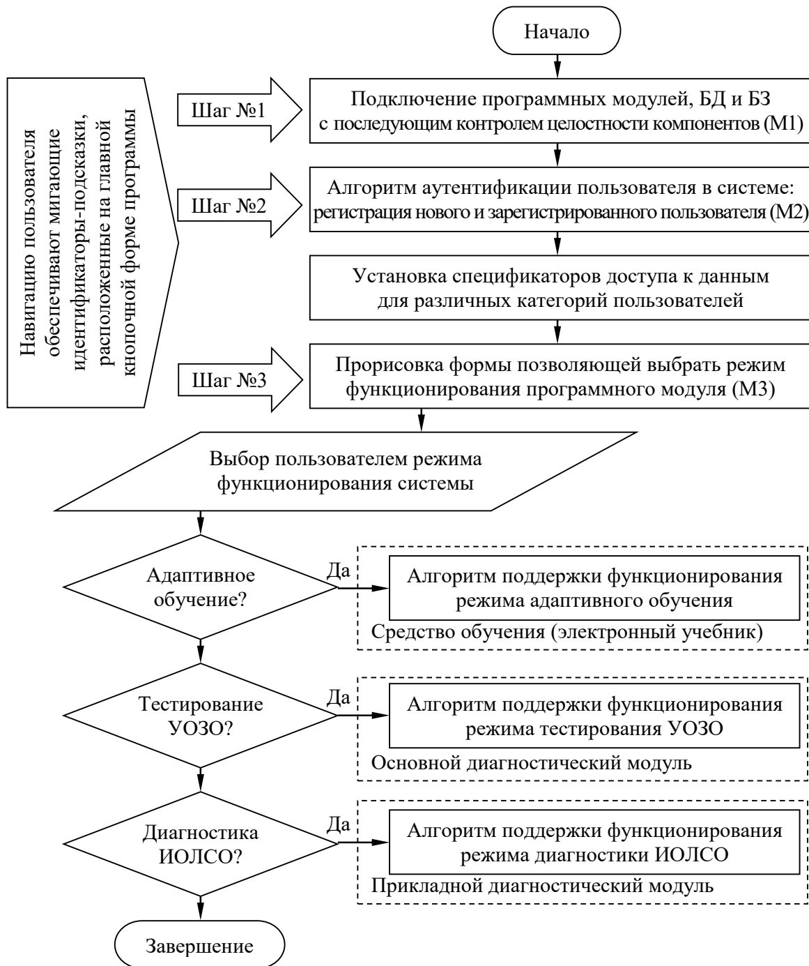
Рисунок 6.2. Алгоритм переключения режимов функционирования программного комплекса
