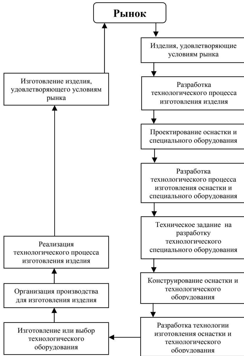
Рис. 1. Модель расширенной производственной системы, замкнутой на рынок
