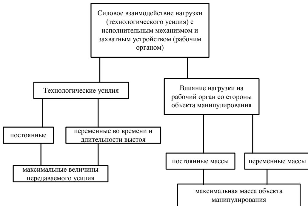
Рис. 8. Характеристики взаимодействия исполнительного механизма с обслуживаемым оборудованием
