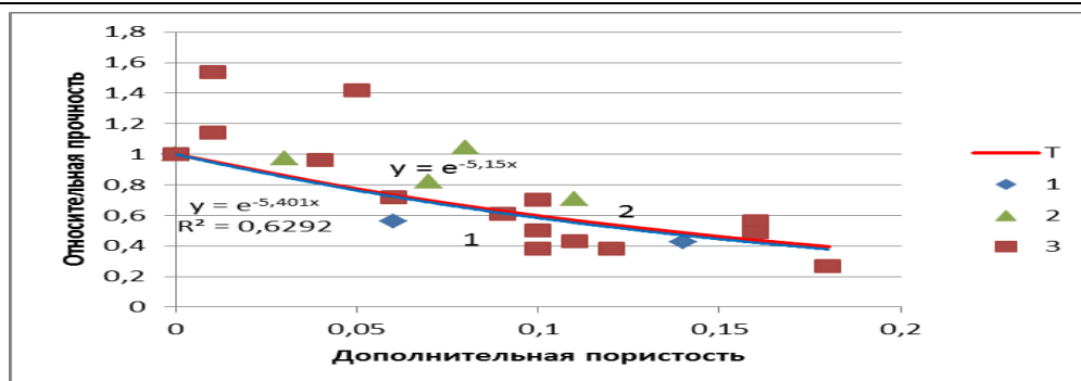
Рис. 3. Зависимость относительной прочности от дополнительной пористости: 1-3 – данные авторов; Т – формула Рышкевича [2]
