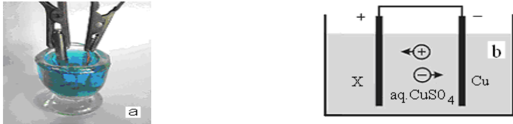
Рис.3. Общий вид электрохимической ячейки <X/Э/Cu> (а) и ее электрическая схема при работе в режиме короткого замыкания (b).
