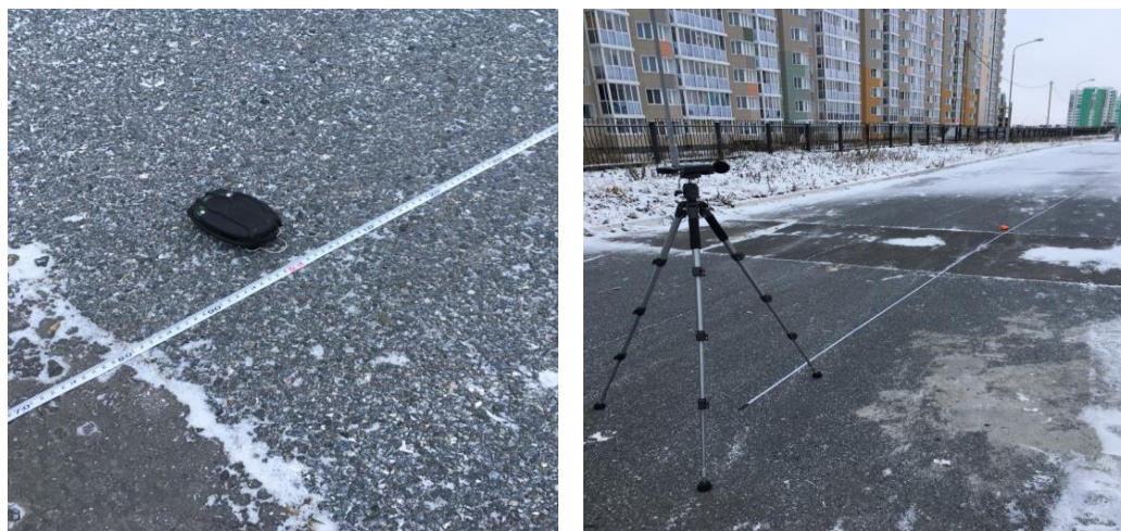
Рис. 5. Измерение уровня звука аварийного сигнала датчиков
