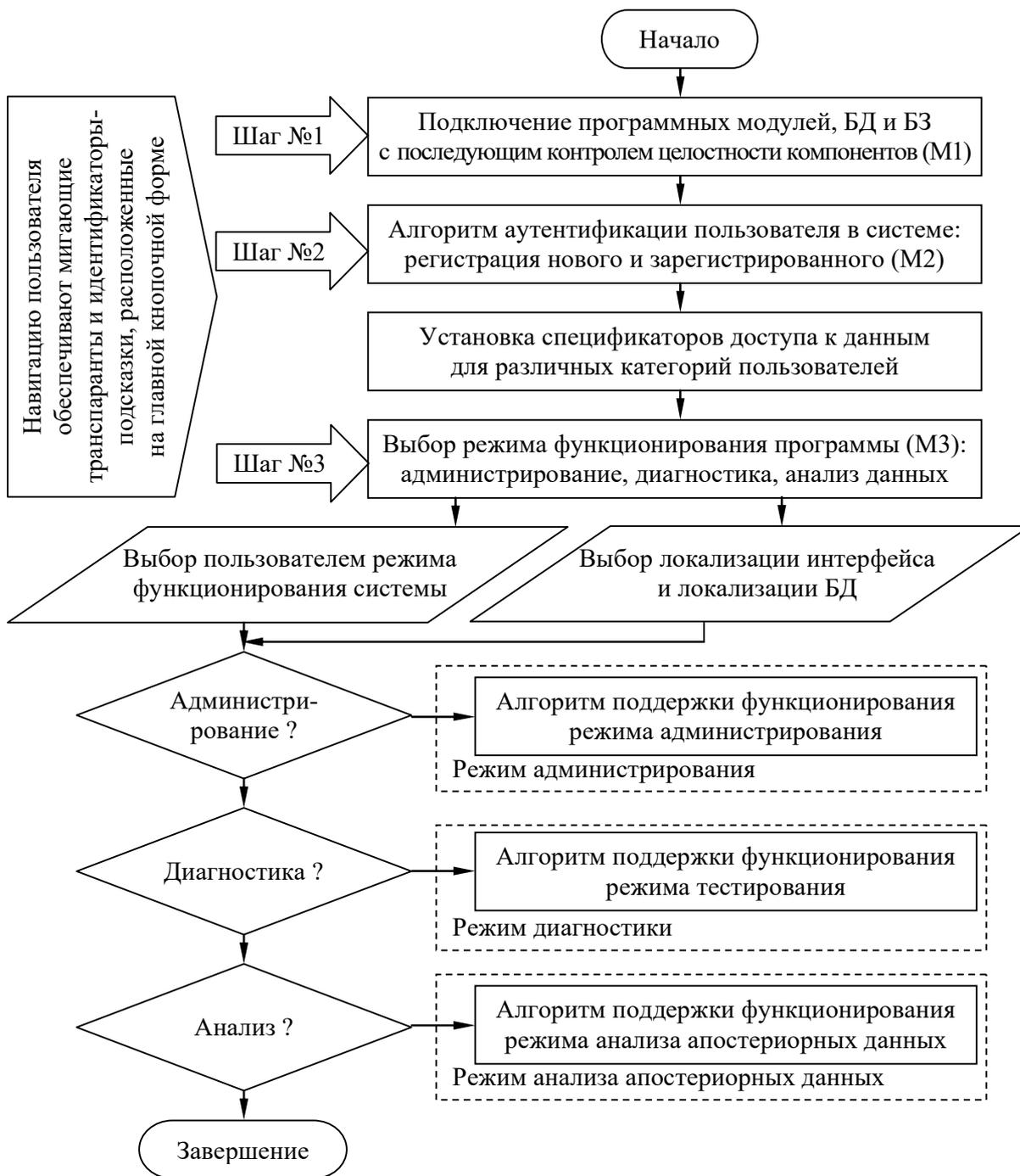
Рис. П2.10. Алгоритм переключения режимов функционирования основного диагностического модуля
