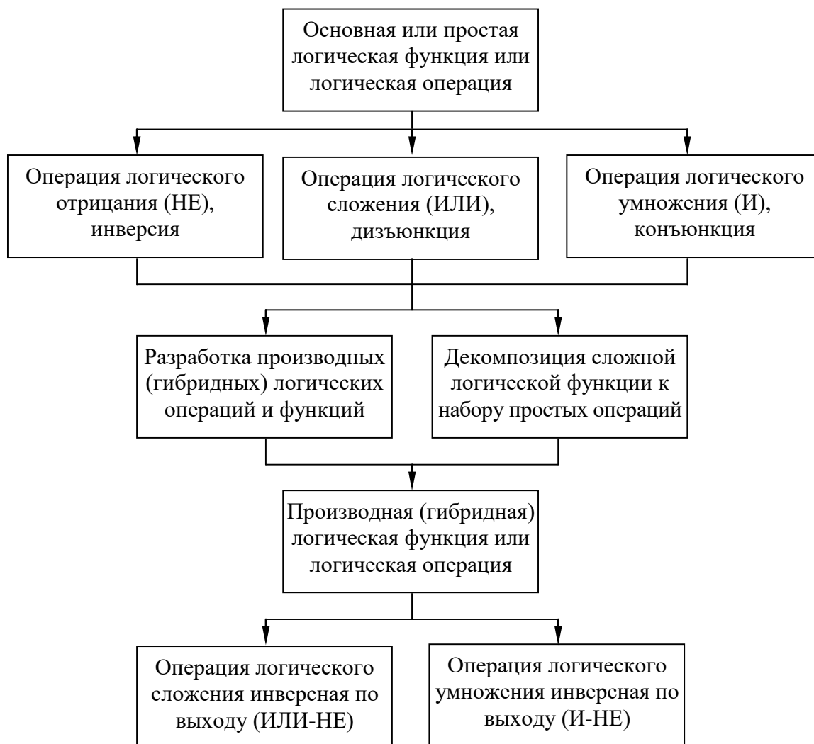
Рисунок 3.8. Простые и гибридные логические операции и функции
