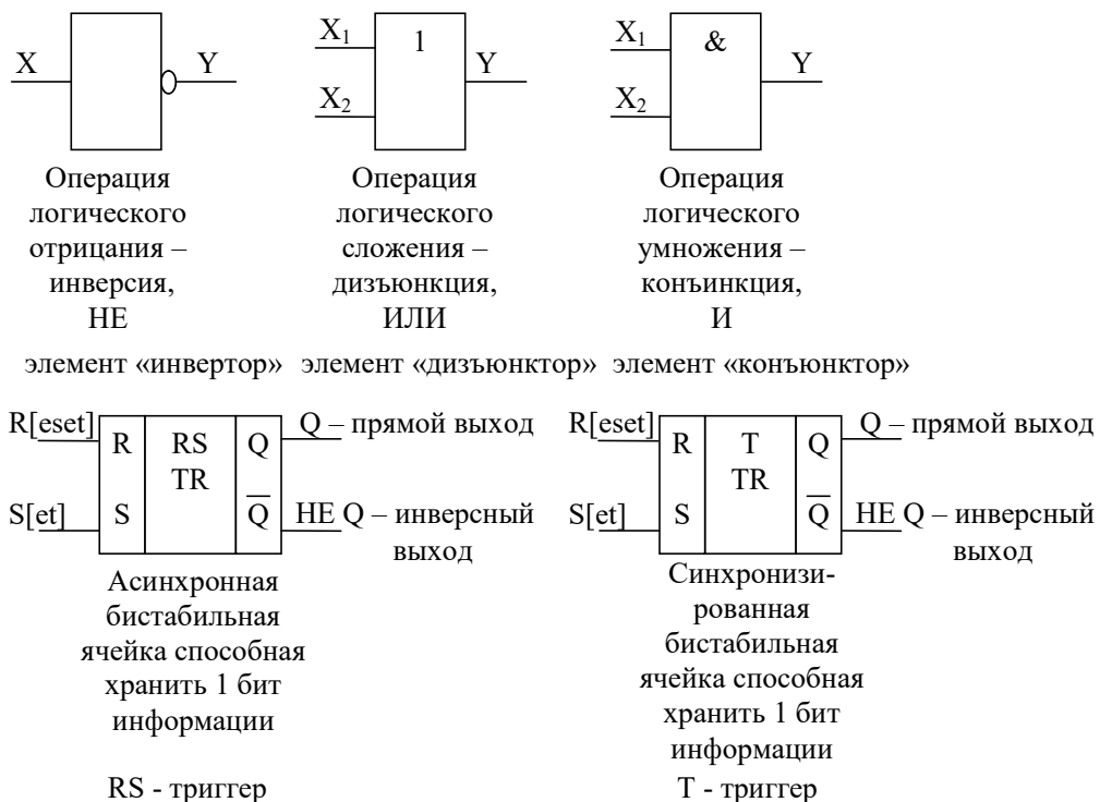
Рисунок 3.3. Условно-графические обозначения логических операций на функциональных схемах
