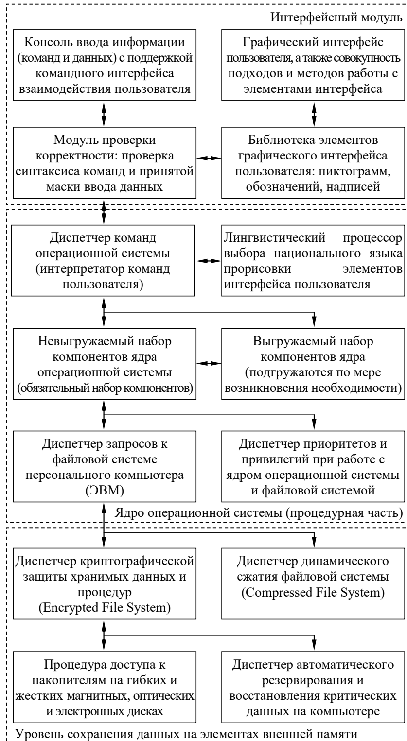
Рисунок 6.4. Типовая структура операционной системы
