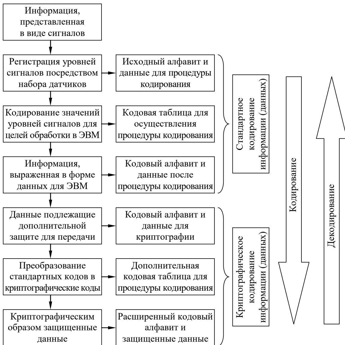
Рисунок 2.1. Структура (де)кодирования информации для ее обработки на компьютере В зависимости от целей кодирования, различают следующие его виды:
