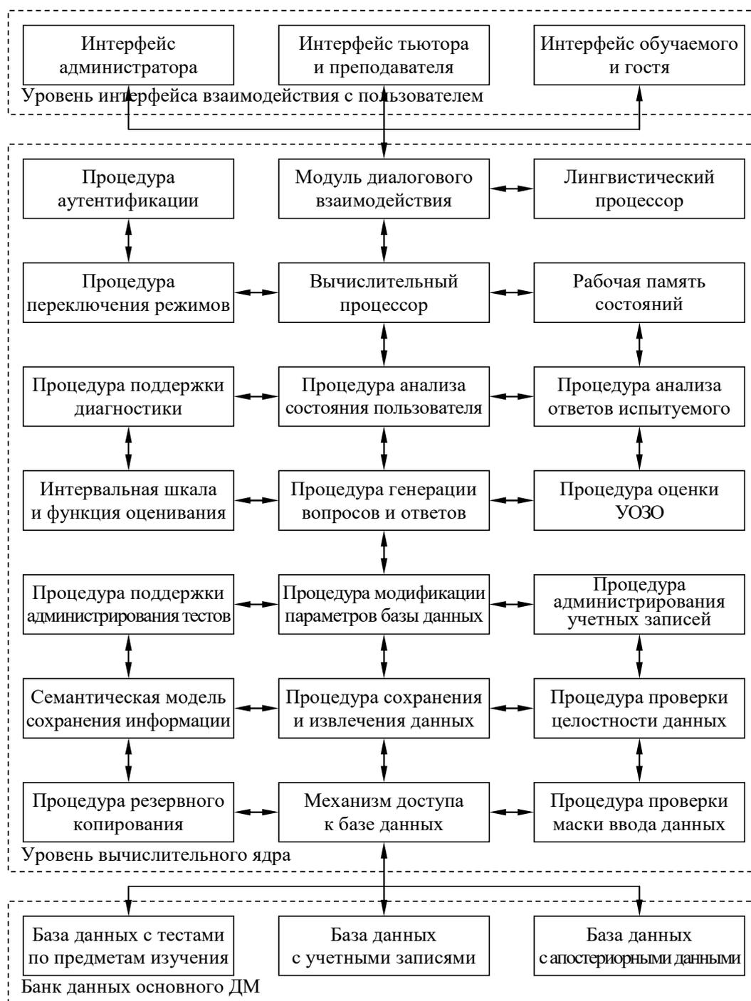
Рис. 2. Обобщенная архитектура основного ДМ
