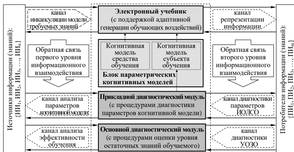
Рис. 1. Структурная схема системы автоматизированного обучения со свойствами адаптации на основе блока параметрических когнитивных моделей
