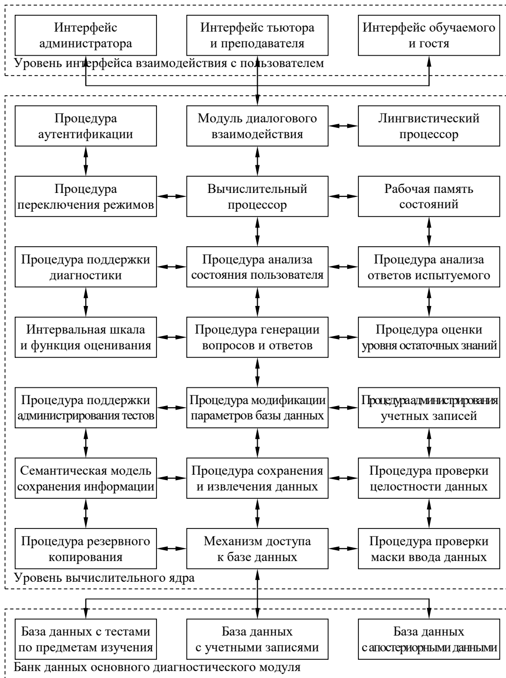
Рис. 2. Обобщенная архитектура основного диагностического модуля
